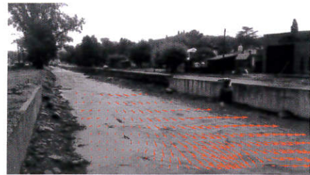
Figura 1. Instantánea del río inundado Río Ceballos y su campo de desplazamiento medio no rectificado.
